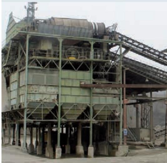
una parte del fabbisogno del gruppo, che è di oltre 450.000 mc/anno. Le lavorazioni di cava prevedono l'escavazione, la selezione e la riduzione volumetrica dei materiali del giacimento minerario per la produzione di aggregati naturali e frantumati delle differenti classi granulometriche richieste per la produzione in regime di marcatura CE, dei calcestruzzi e dei conglomerati bituminosi.
